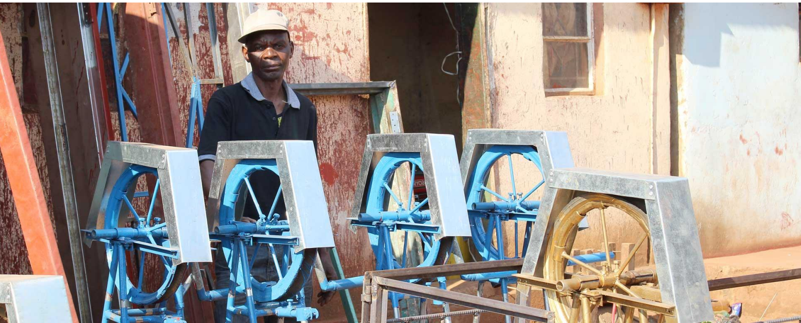
Das Projekt bildet Handwerker dazu aus einen lokal produzierten Handpumpentyp («Rope Pump») herzustellen. (© Jacana)
